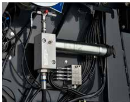
5. Стандартная система автоматической смазки роликовых подшипников
