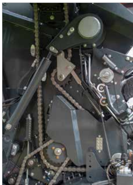
8. Надежный привод с износостойкими и крупноразмерными цепями
