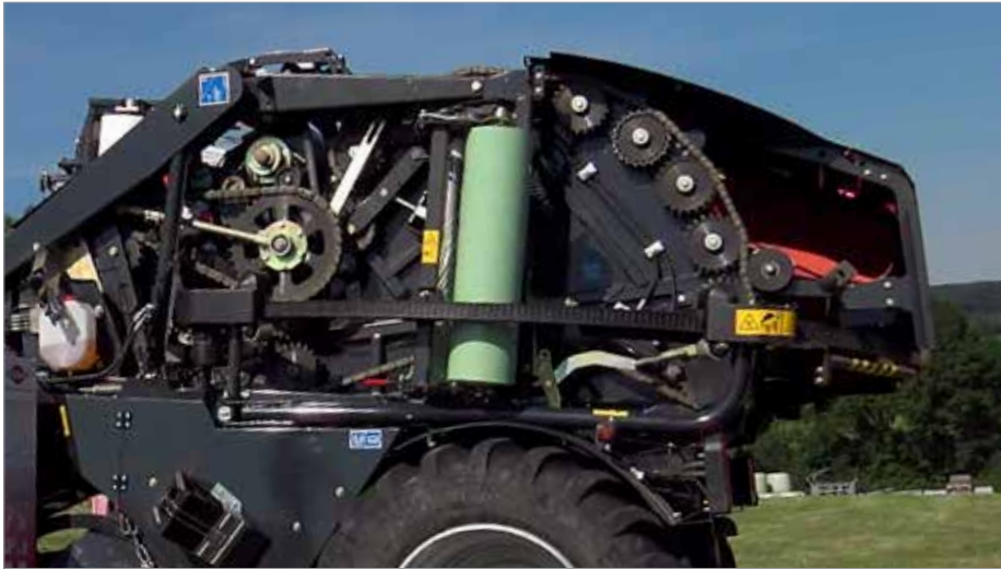
1. Надежный привод с использованием высококачественных цепей IWS
