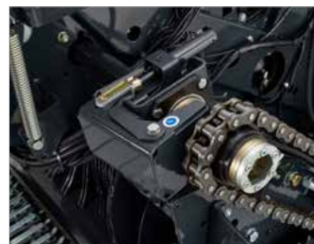
4. Стандартное гидравлическое отключение ротора
