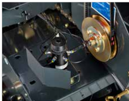
5. Система непрерывной смазки цепей ВЕКА-MAX
