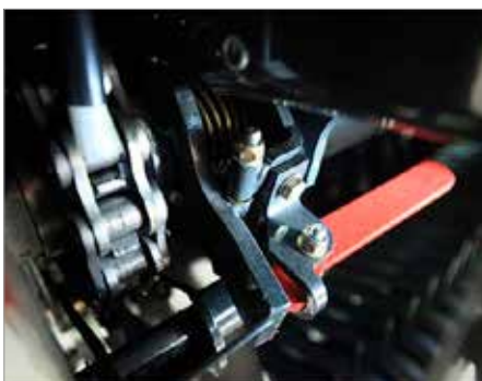
4. Механическое отключение ротора
