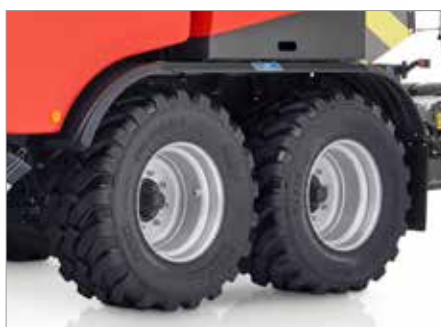
9. Сверхбольшой тандем с шинами 500/60R22,5
