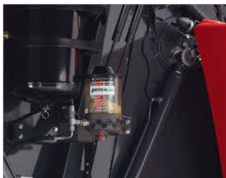
10. Автоматическая система консистентной смазки
