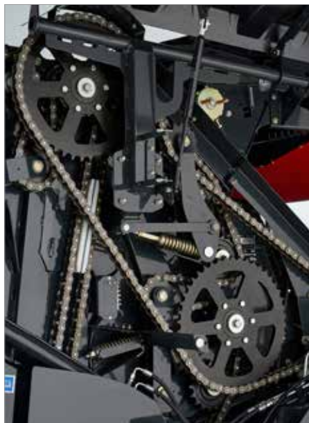
1. Надежный привод с использованием высококачественных цепей IWIS
