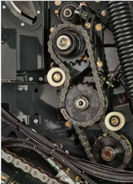
1. Второй ведомый ролик обеспечивает надежный ременной привод при любом состоянии кормовых культур.
