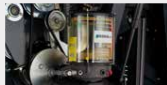
Резервуар для смазки массой 4 КГ
