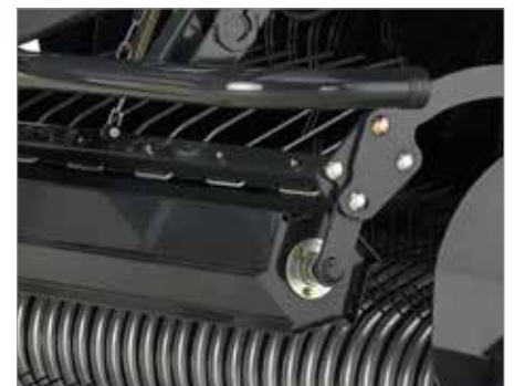
4. Усиленный ролик кормовой массы с ветровым щитом (Ø217 мм)
